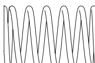
OD1560 ショックスプリング (線径1.3, 巻数9, 自由長28mm/ブラック) Shock Spring (1.3x28mm 9coils/Black)
